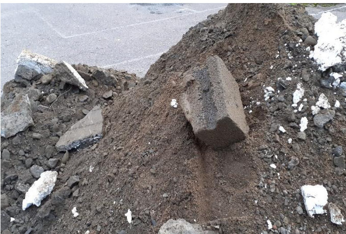
Kuva 9. Koekuopan 30 pintamaassa oli muita kuoppia enemmän styroksia ym. rakennusjätettä.
